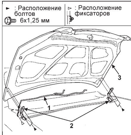
Снятие капота. 1 - трубки форсунок омывателя ветрового стекла, 2 - болты, 3 - капот.
