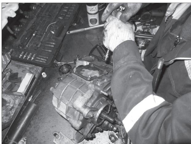
Рис. 1.40 Отверните четыре гайки крепления лючка
