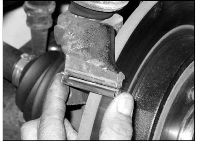
Снимите с опорных выступов кулака стальные скользящие накладки - противоскрипные пружины.
