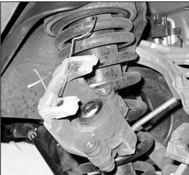
Не оставляйте суппорт висеть на тормозном шланге - подвяжите его проволокой к рессоре.
